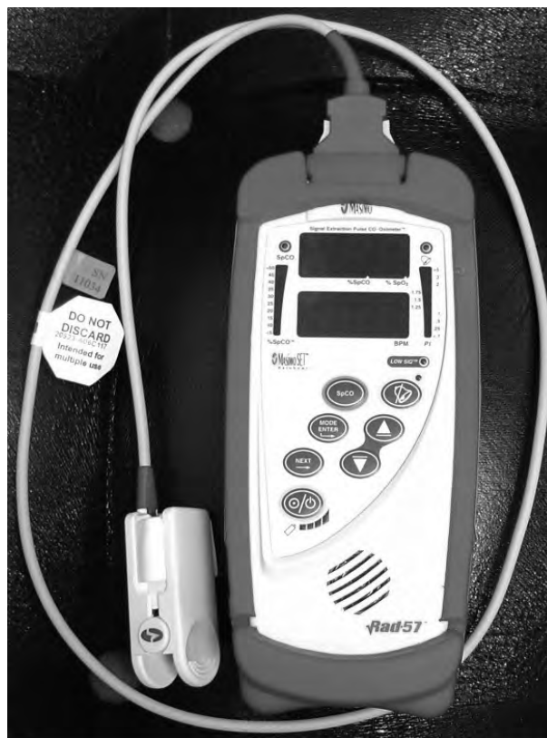
Figura 3. Aparato para estimar la concentración de carboxihemoglobina por pulsioximetría.
