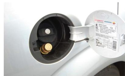
**Figura 2.** Válvula de alimentación de gas licuado de petróleo (GLP), en la boca de suministro de carburante.
