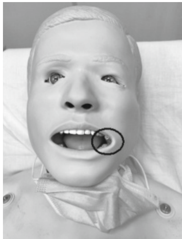
Figura 1. Mecanismo de nebulización de gotas (MAD Nasal™) instalado en el ALS simulator.
